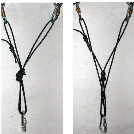
Fig. 2: Sosta fissa con unico nodo sui rami (sinistra) o nodi separati sui singoli rami (destra).
