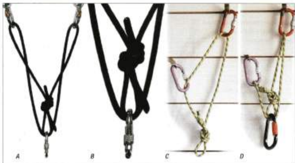
Fig. 4: La sosta ad asola inglobata (A), un particolare del nodo al vertice (B). Metodo alternativo per la realizzazione, (C) e (D).
